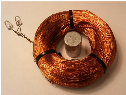
Figur 1: En spole för att demonstrera Faradays induktionslag.
