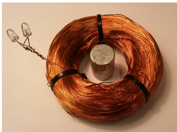
Figur 1: En spole för att demonstrera Faradays induktionslag.
